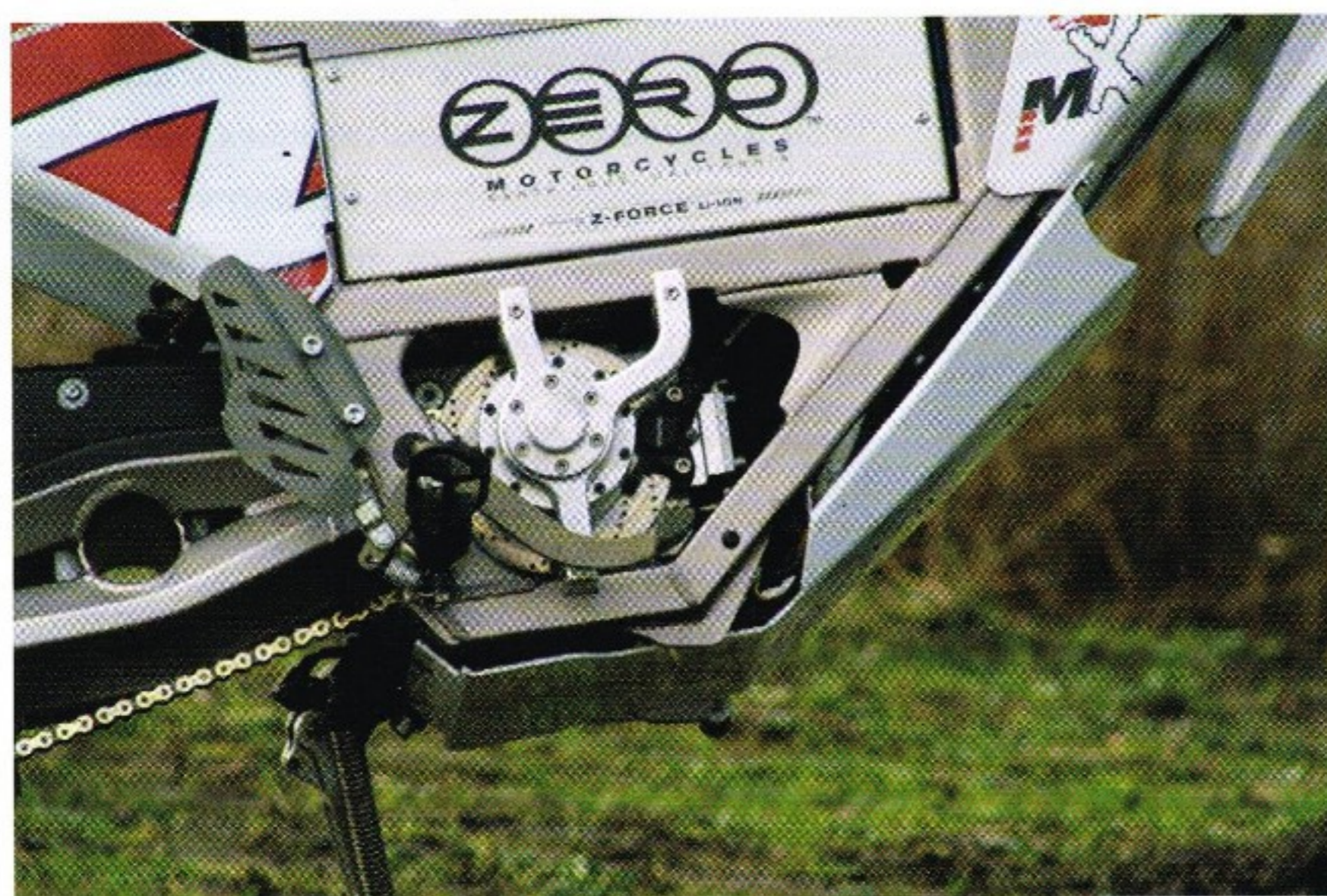
Deze elektrische crossmotor is met de compacte SmeshGear uitgerust. Met de remcilinder boven het rempedaal kan het ringtandwiel worden vastgezet
